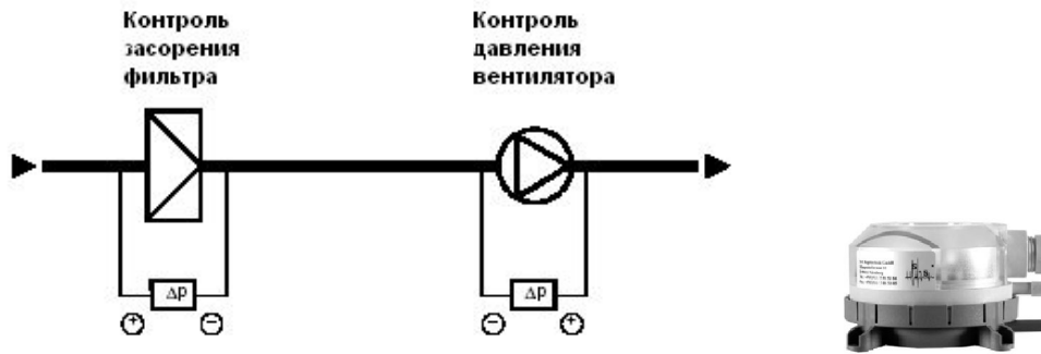
Рисунок 4. Внешний вид и примеры использования датчиков давления.
