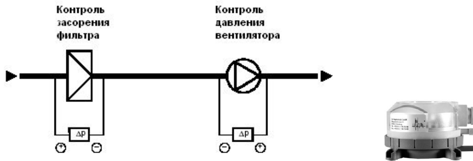
Рисунок 4. Внешний вид и примеры использования датчиков давления.
