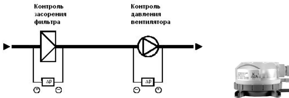
Рисунок 3. Внешний вид и примеры использования датчиков давления.
